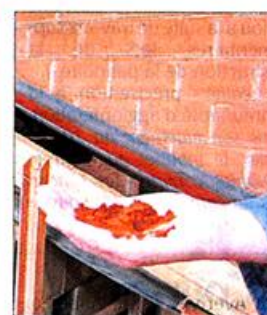
La fabrication de terre battue est en fait le résultat d'une valorisation de déchets. Les détrit de brique sont pilés pour devenir du gros sable destiné au terrain de tennis
