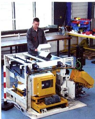
L'usine Michelin de Cholet, en partenariat avec Eurespace Formation, a intégré en juillet une nouvelle machine qui enroule la gomme sur une bobine en isolant chaque couche par une fine matière intercalaire. Le dispositif se compose de deux enrouleuses identiques et d'une armoire électrique, implantées à la suite d'une ligne de production. Il a été entièrement conçu et réalisé par une équipe de 11 apprentis en 2<sup>ème</sup> année du BTS CRSA (Conception
