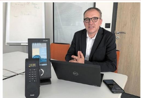
Cédric Lampin, responsable marketing et communication de Bodet Software, a notamment piloté la conception du terminal Kello Xtrem, au premier plan, un lecteur d'accès permettant une identification par badge RFID, clavier à code ou biométrie par empreintes digitales.
