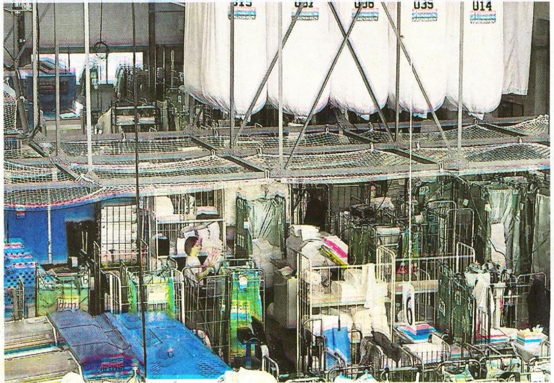
Dans les nouveaux locaux, le linge est exclusivement convoyé en aérien d'un poste à l'autre.
